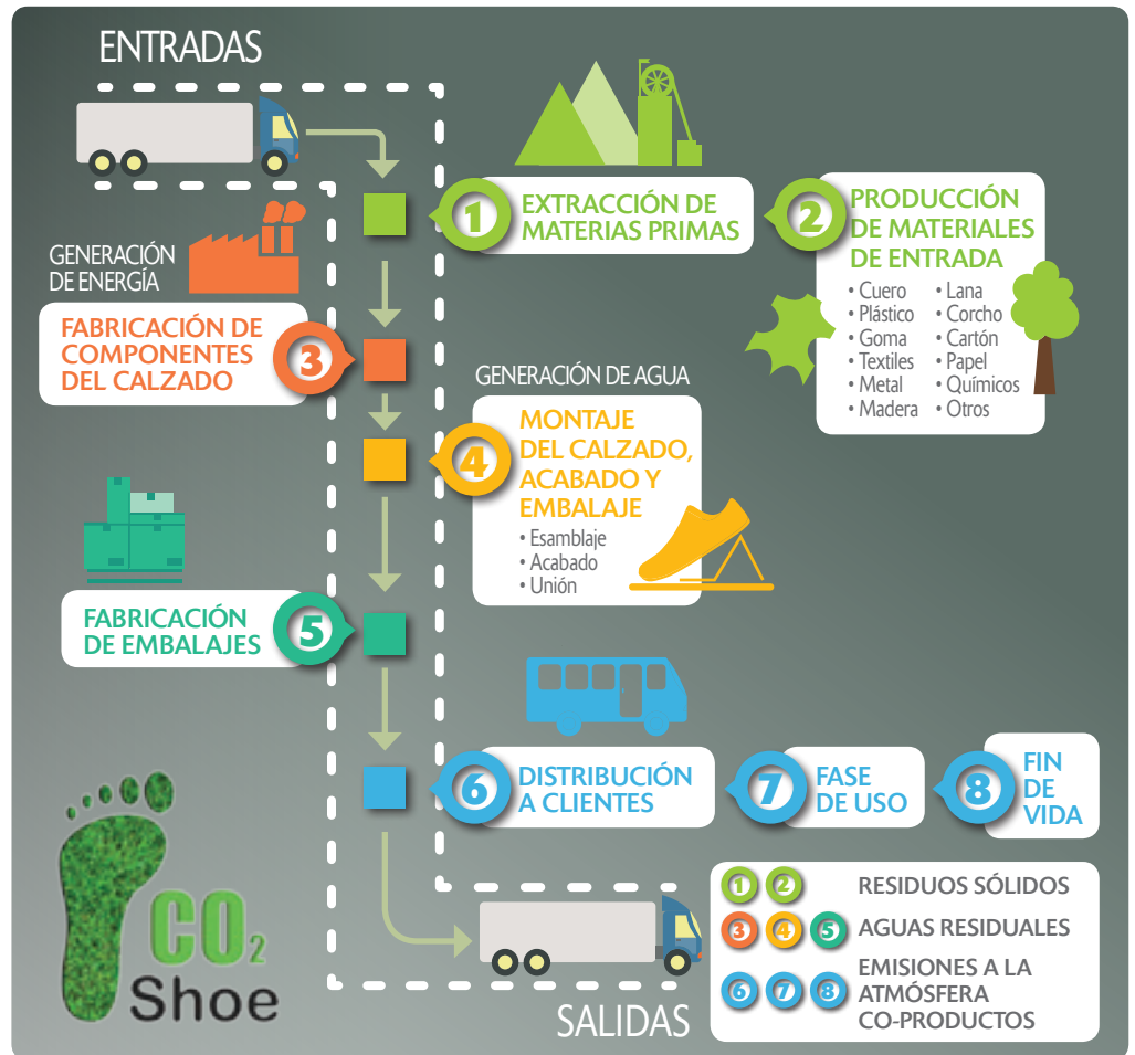
Gráfico 1 Diagrama de flujos del sistema analizado
